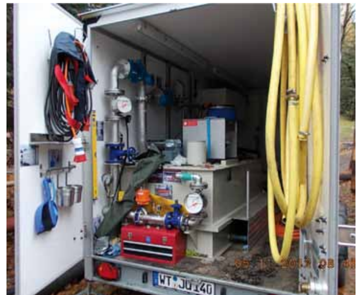
Container mit Reifekammern und zur Zuführung des Flockungsmittels
